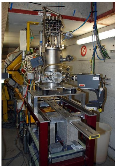
Figure 2 : Dispositif CHILDS d'études in-situ des propriétés mécaniques des matériaux sous irradiation et en température.
